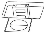
**自動鎖模式**是讓您在平滑的平面上進行掃描時使用的。當保護鎖是向外彈開的狀態時，掃描器會呈自動上鎖狀態。在平常使用時，我們建議採用這個模式。
